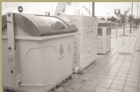
Se suelen emplear contenedores de plástico de entre 120 y 1100 litros de capacidad.
