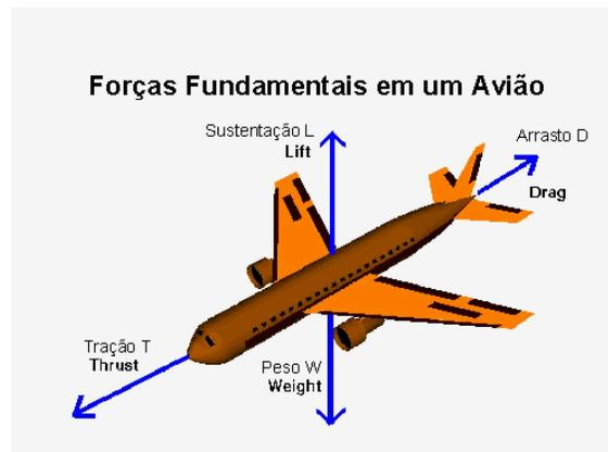
Figura 1. As forças fundamentais atuando em uma aeronave em vôo.
