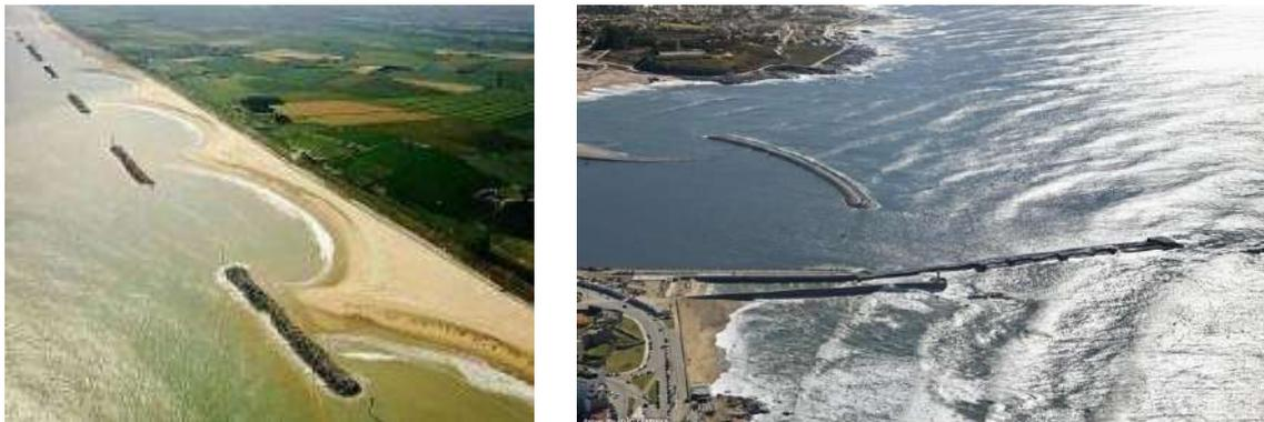
a) Campo de quebra-mares destacados      b) Quebra-mar destacado (molhe Sul da Barra do Douro)
