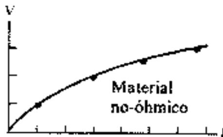
Un conductor no-óhmico no posee un valor único de resistencia, y su gráfica de  $V$  frente a  $i$  no es una línea recta.
