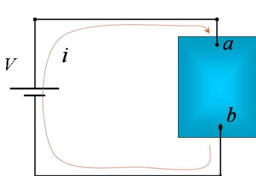
La terminal  $a$ , conectada con el borne positivo de la batería está a mayor potencial que la terminal  $b$ . Si se mueve una carga  $dq$  de  $a$  a  $b$ , esta carga disminuirá su energía potencial eléctrica en una cantidad  $dq * V_{ab}$
