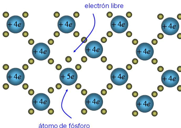
Cuatro de los cinco electrones de valencia de cada átomo de fósforo estarán ligados al ion de fósforo (en la misma disposición de los electrones alrededor de los iones de silicio), y el electrón restante está siempre prácticamente libre a temperatura ambiente. Por tanto esencialmente cada átomo de la impureza de fósforo cede un portador de carga negativo, electrón libre al material.
