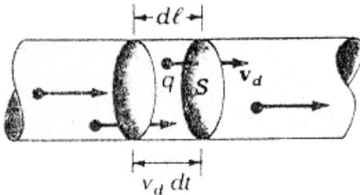
En la figura suponemos que todos los portadores llevan una velocidad  $v_d$ , de forma que todos los portadores que hay en el cilindro de longitud de  $dl$  pasan a través de la superficie  $S$  en un tiempo  $dt$
