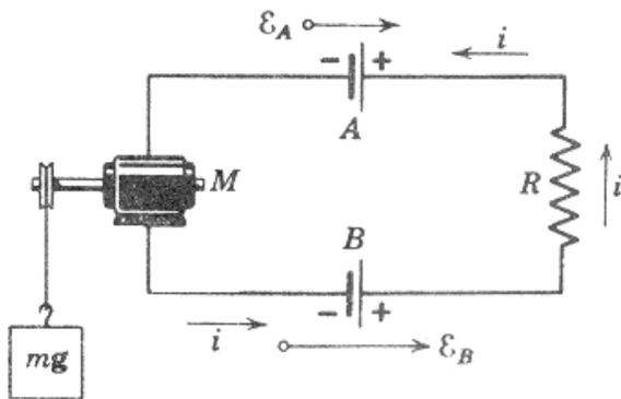
Las baterías se conectan de tal manera que tienden a mandar cargas por el circuito en direcciones opuestas; la dirección definitiva de la corriente queda determinada por B, que proporciona la mayor diferencia de potencial.
