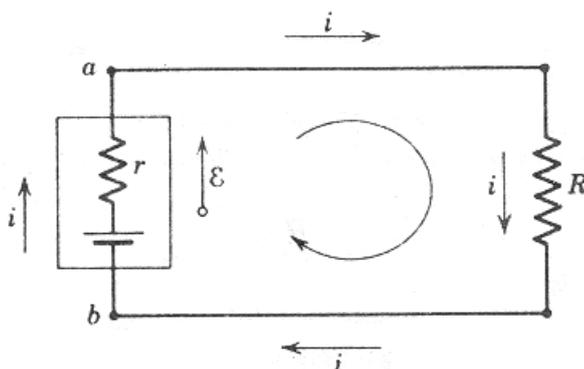
Si aplicamos la ley de las mallas, comenzando en el punto  $a$  y dando la vuelta en el sentido de las manecillas del reloj, obtenemos:
