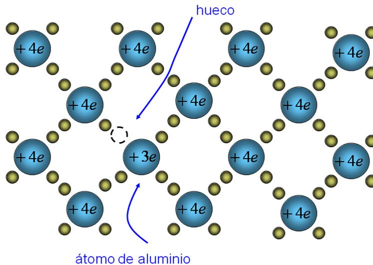
A temperatura ambiente el hueco, formado por la falta de un electrón de valencia en el aluminio, está prácticamente siempre libre, de forma que casi todos los iones aluminio tienen cuatro electrones a su alrededor, como los de silicio.
