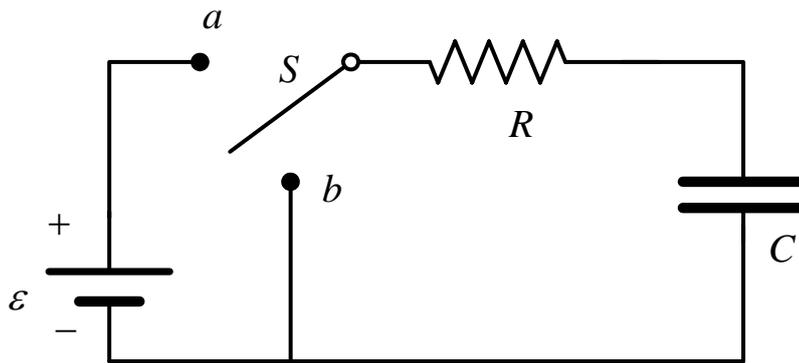
Colocamos la llave en la posición  $a$ , en esta situación analizamos la corriente que comienza a circular. Realizamos nuestro análisis aplicando los principios de la conservación de la energía
