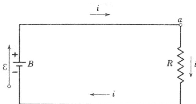
En el circuito exterior a la fem los portadores positivos de carga se moverían en la dirección que muestran las flechas representadas por  $i$ . En otras palabras, se produciría una corriente en el sentido de las manecillas del reloj.
