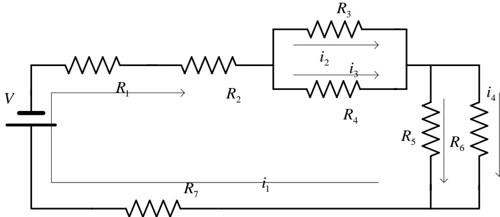
En el circuito anterior resolvemos el equivalente paralelo entre las resistencias  $R_5$  y  $R_6$
