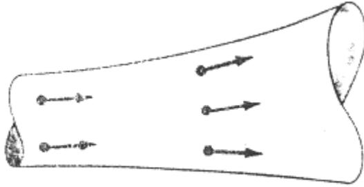
Si la velocidad de arrastre de los portadores varía, como se ve en la figura, la densidad de corriente variará en la misma forma
