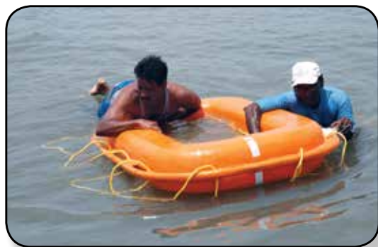
Flotador salvavidas de PRF para embarcaciones más grandes, como alternativa a una balsa salvavidas inflable*
