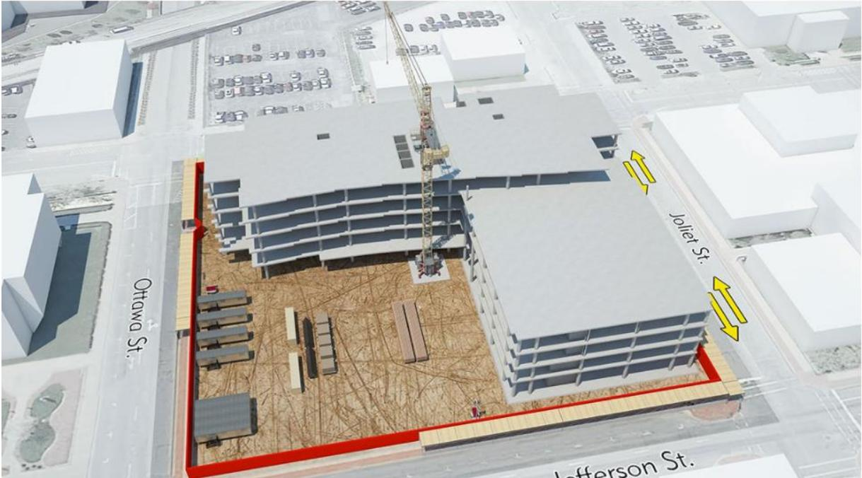
Figura 25 – Visualização em RV do layout de uma obra através do Unreal Engine (UNREAL ENGINE,2021).
