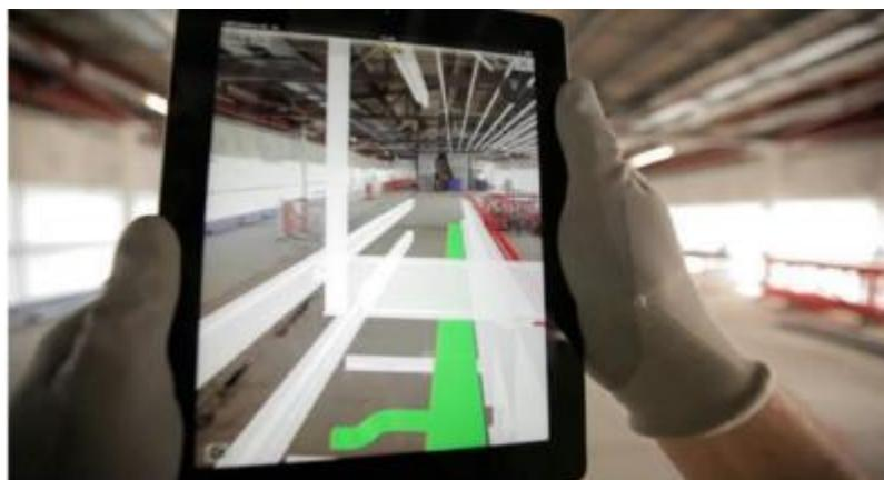
Figura 29 – Sobreposição de projeto hidráulico utilizando App de Realidade Aumentada (FREITAS,2015).
