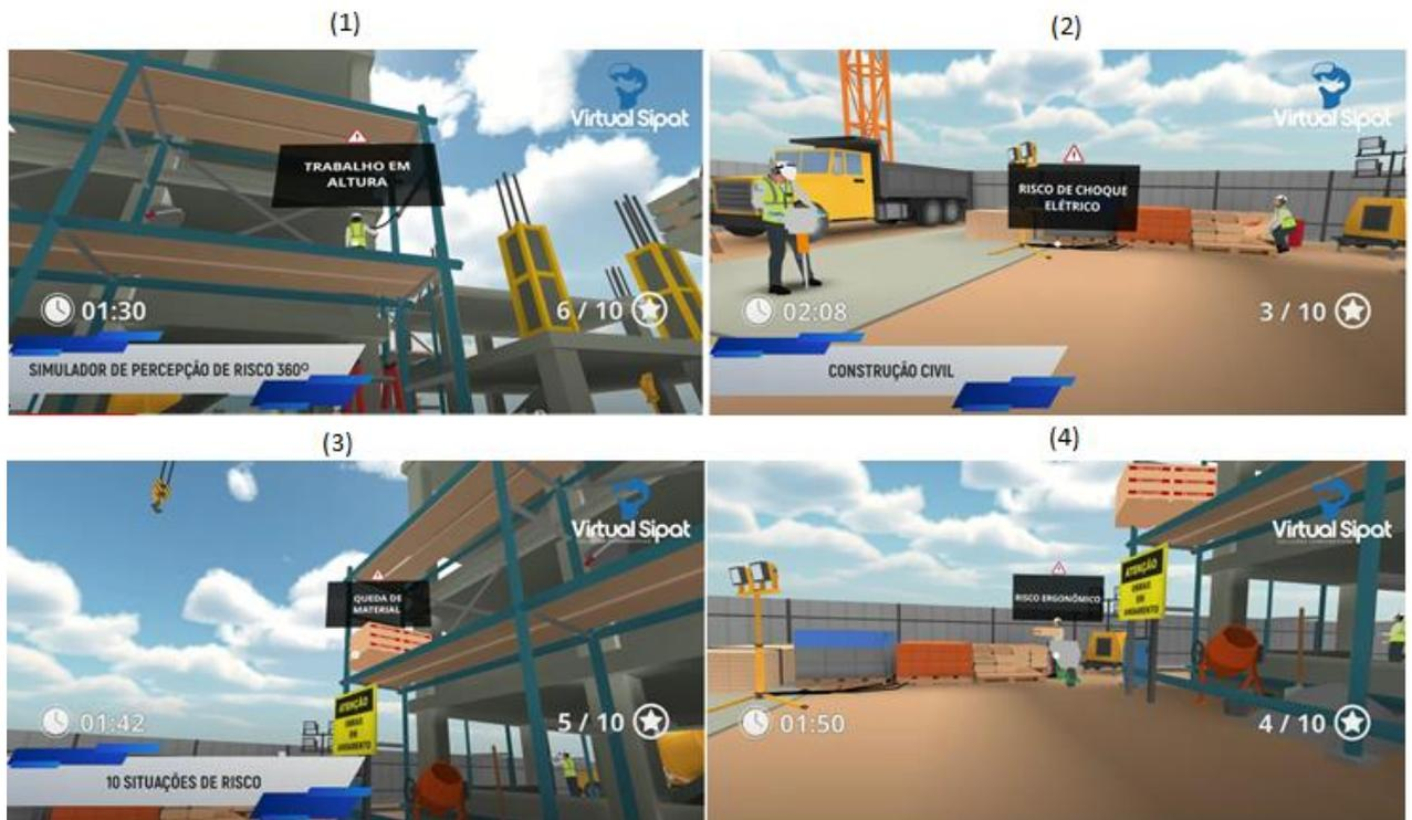
Figura 40 – Simulador de percepção de riscos da Virtual Sipat. (1) Risco: trabalho em altura. (2) Risco de choque elétrico. (3) Risco: Queda de material. (4) Risco ergonômico (VIRTUAL SIPAT,2020).
