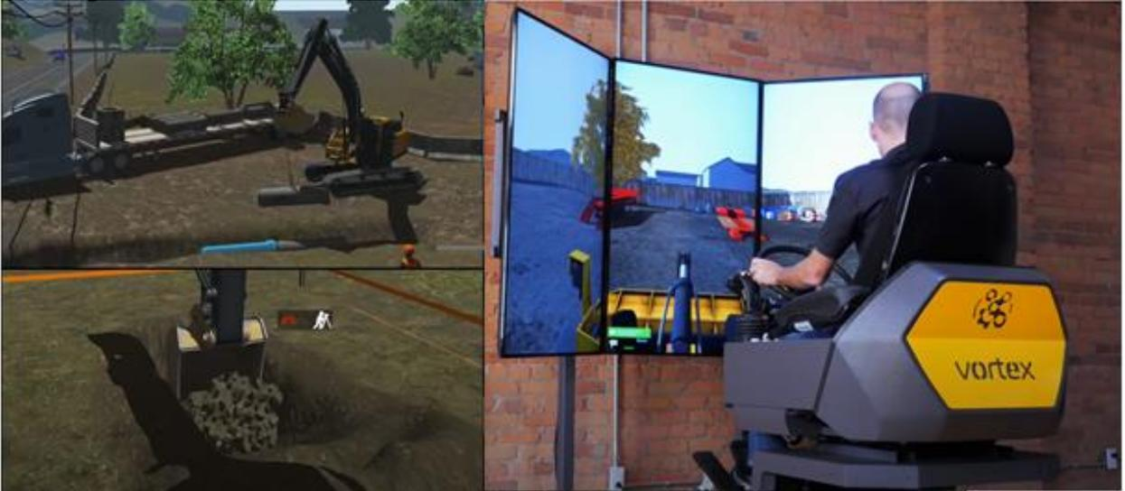
Figura 39 – Treinamento em um simulador de escavadeira e de trator de esteira (CMLABS,2021).
