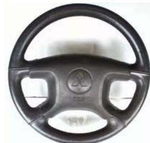
O primeiro componente do sistema de direção é o volante de direção, que permite, através do comando do motorista, o movimento giratório que será levado até a caixa de direção. Existem muitos tipos de volantes de direção, clássicos, esportivos e os futuristas. O volante tornou-se um componente de interatividade com o motorista, principalmente os automóveis que dispõem de alguns comandos alternativos de outros sistemas no volante.
