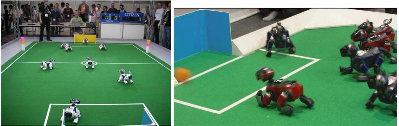
Fig. 18 - Os *robôs* que jogam futebol, como os cãesinhos *Aibo* da SONY, também dependem da *visão robótica* para se orientarem no campo, localizarem a bola, o golo, etc.
