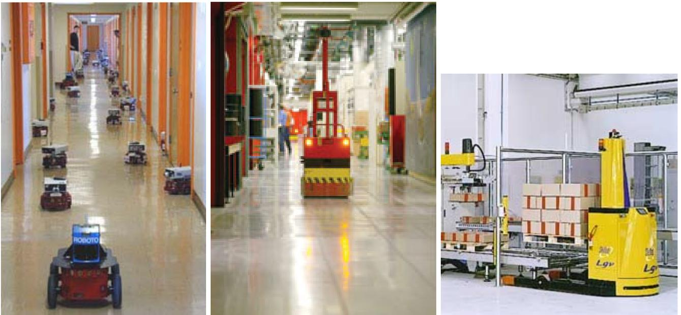
Fig. 17 - *Robôs* que se deslocam automaticamente dependem da *visão robótica*. Estes *robôs* são chamados *AGV (Automated Guided Vehicles)* e *LGV (Laser Guided Vehicle)*, frequentemente usados para fazer o *transporte de materiais* na indústria (caso das fotos ao centro e à direita). Nós voltaremos a falar neles no próximo capítulo (*Robôs na indústria*).
