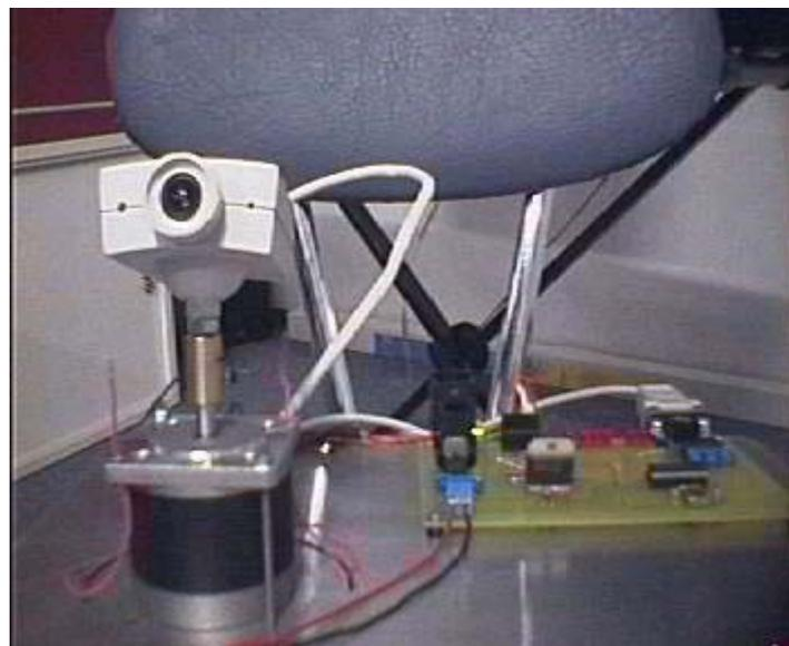
Fig. 25 - Motor de passo controlando webcam.
