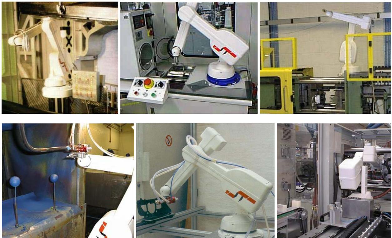
Fig. 14 - Um *robô flexível* fazendo diferentes tarefas (na indústria da música e de vídeos). O mesmo *robô* coloca e tira peças na máquina de moldar, pinta, pulveriza, faz banho, faz limpeza de pequenas lentes, etc.
