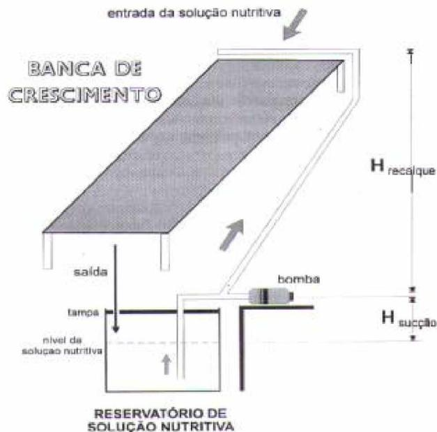
**Figura 02 – Esquema de um Sistema Hidráulico.**
