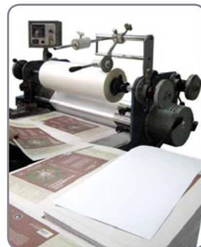
Figura B.17 – Máquina plastificação e termolaminação (Fonte: ver lista de créditos de imagens 15)
