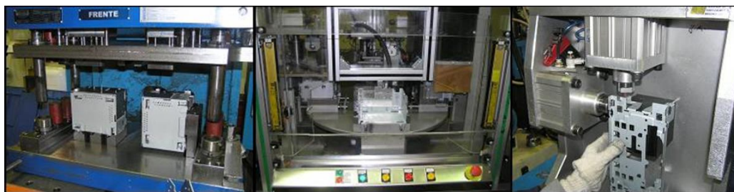
Figura 3. 22 - Máquinas e Ferramentas de Cravação.
