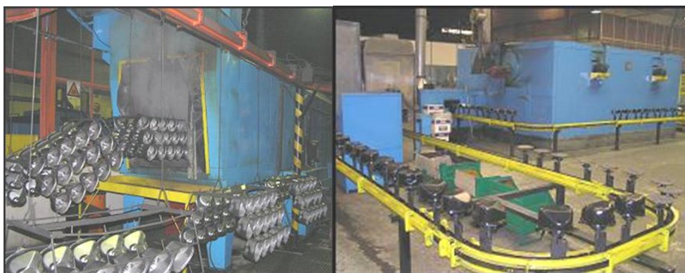
Figura 3. 13 - Linha de Tratamento de Superfícies e Pintura.
