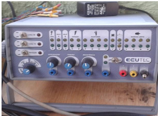
Figura 10 Simulador de ECU ECUTEK 20100, Do Autor
