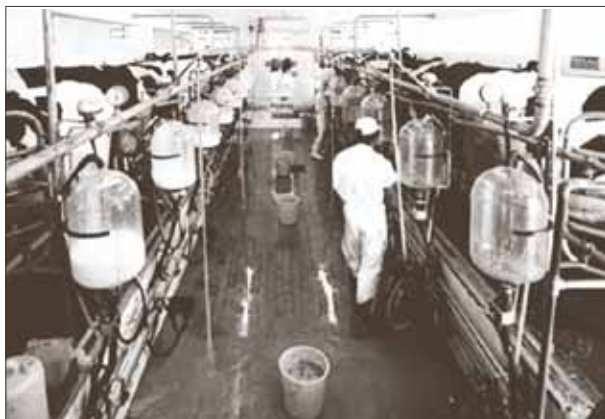
FOTOGRAFIA N.º 1 - Sala de ordenha equipada com sistema de controlo individual de produção e de recolha de amostras para laboratório.
