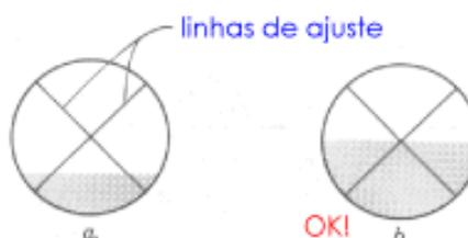
Figura 8.3 - Campo de visão do refratômetro.
