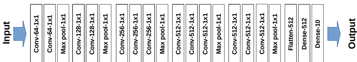
Figura 4.3: Estructura del modelo VGG16. Todas las capas contienen una activación ReLU, excepto la última que contiene un softmax para la clasificación.
