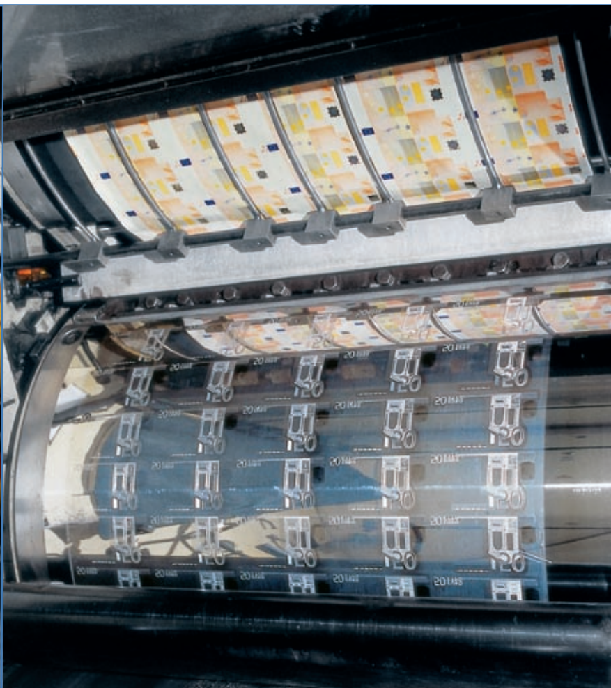
O cilindro impressor de notas de €50 de uma máquina de impressão em talhe doce.
