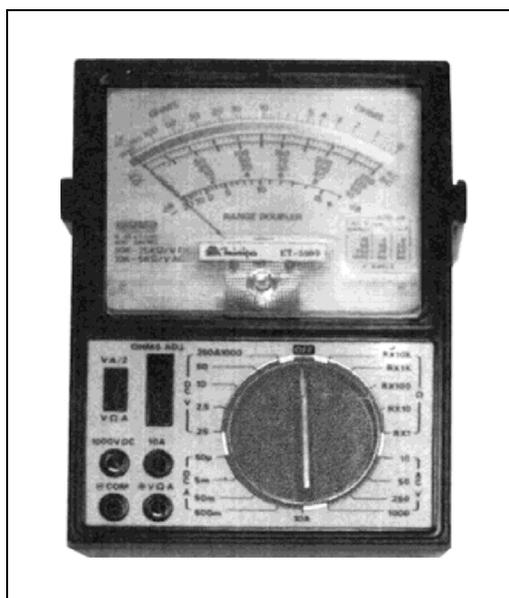
O multímetro analógico normalmente é composto por escalas graduadas de leitura, ponteiro, parafuso de ajuste do ponteiro, chave seletora de função, bornes de conexões, escalas das funções e botão de ajuste de zero ohm.
