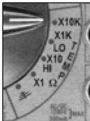
Ao selecionar a escala X1, o valor indicado pelo ponteiro é, exatamente, o valor da resistência em medição. Se a chave seletora estiver na escala X100, o valor indicado deve ser multiplicado por 100, e o mesmo ocorre com as escalas X1K e X10K, ou seja, multiplica-se o valor indicado por 1.000 e 10.000.
