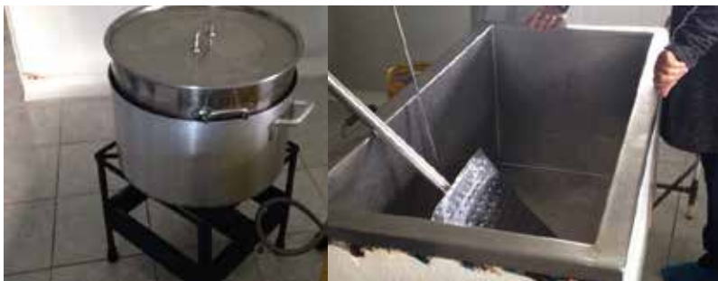
Figura 8.3. Olla en baño María y tina pequeña para pasteurizar la leche.
