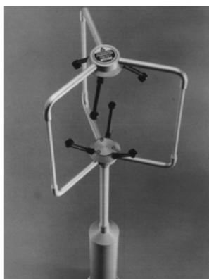
Figura 19: Anemómetro sónico [DeMonfort].
