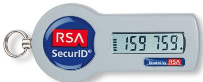
Figura 28.2: Gerador de senhas descartáveis (fotografia de Mazh3101@Wikipedia).
