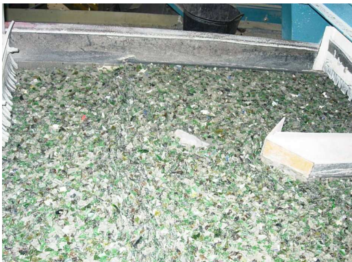
Figura 15. Clasificación de vidrio por tamaño en las instalaciones de Camacho Reciclyng.
