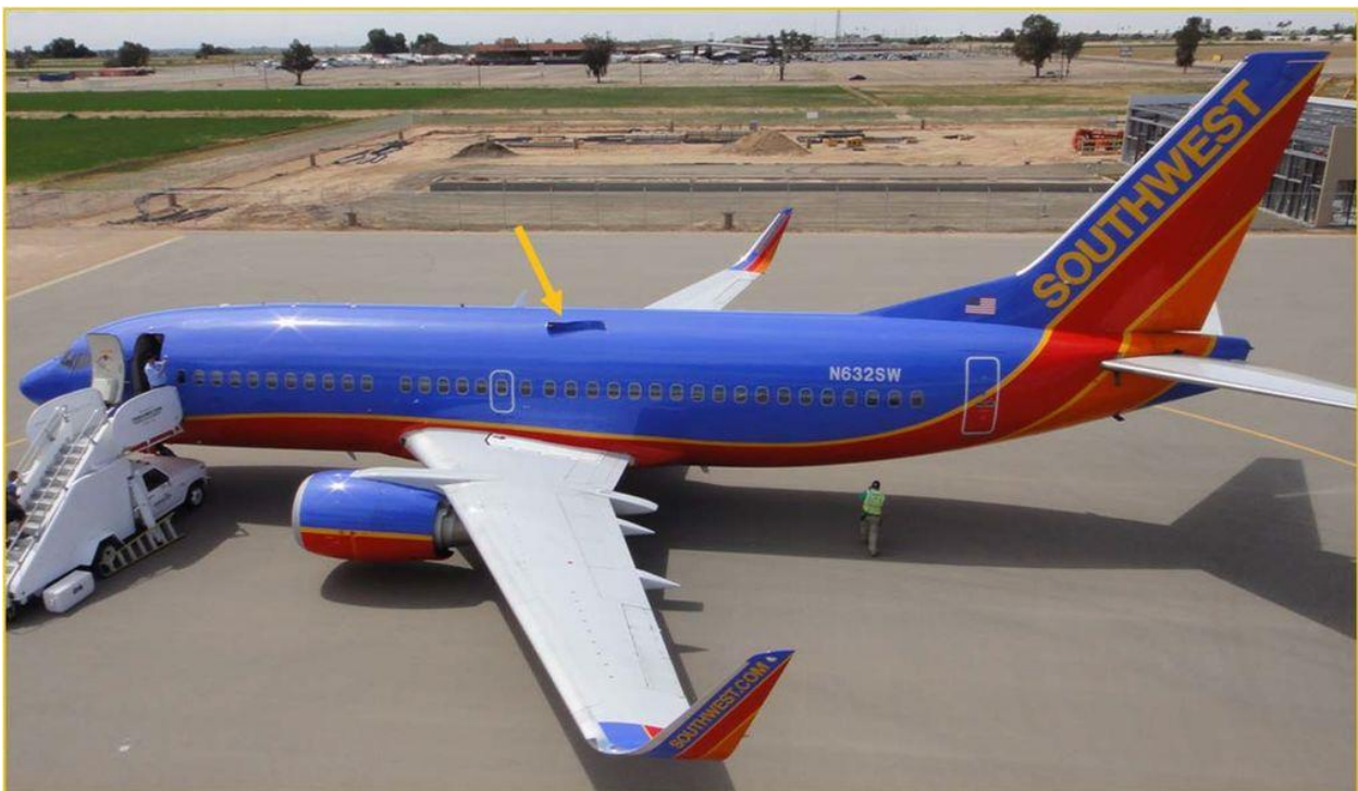
Ilustración 24.- Avión siniestrado donde se puede comprobar el agujero en el fuselaje. [31]
