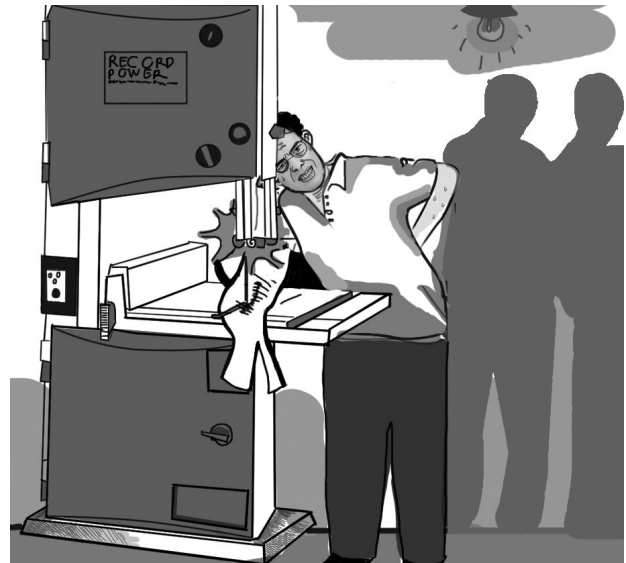
2 - Las máquinas sin guardas ni protecciones pueden aumentar la exposición a sus partes móviles y la posibilidad de accidentes.
