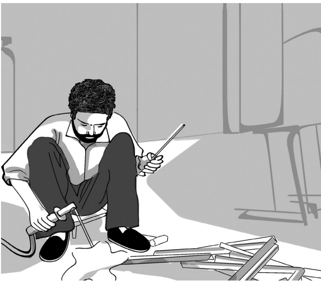
3 - No proporcionar cascos de soldadura expone los ojos, la cara y el cuello de los trabajadores a quemaduras de la córnea, calor y luz infrarroja y ultravioleta. Siempre se debe proporcionar protección adecuada para las manos, tal como guantes, ya que las lesiones en las manos son muy comunes.
