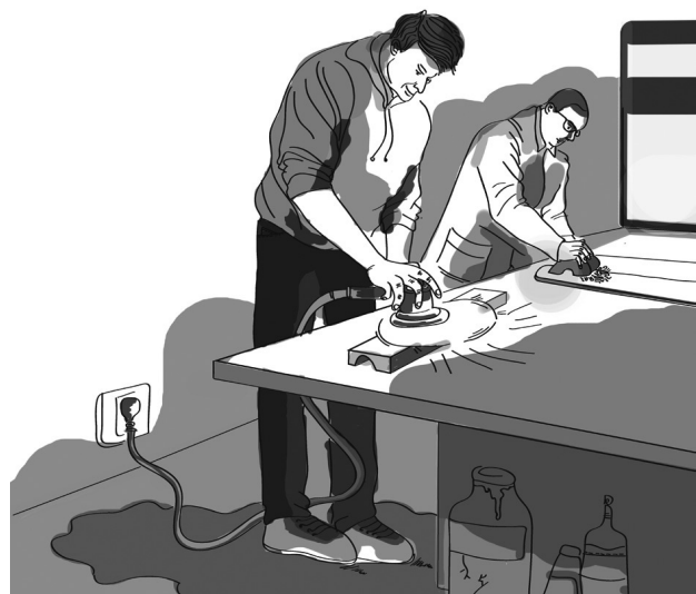
4 - Un cable eléctrico sobre un piso mojado puede provocar cortocircuitos e incendios en el lugar de trabajo, y ocasionar muertes.
