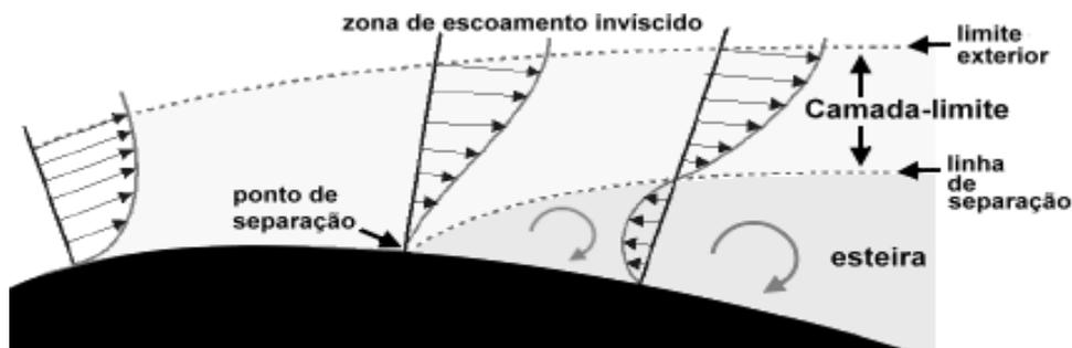
Figura 29 – Esquema da separação da camada-limite.
