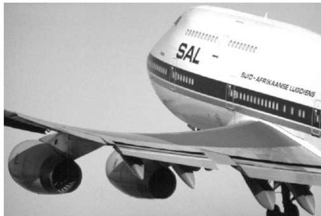
Figura 27 – Flexão alar na decolagem (“Boeing 747”).
