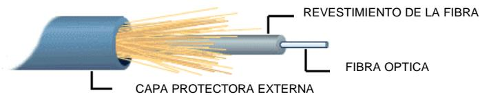
Figura 4.7 Cable de fibra óptica
