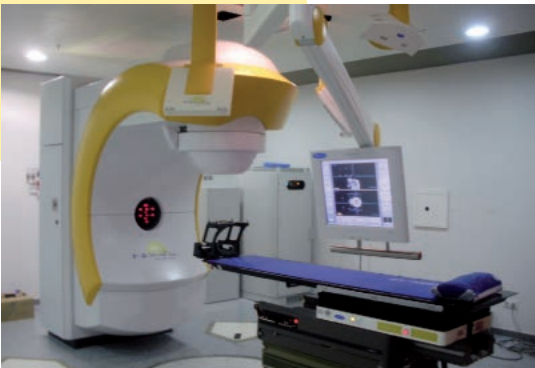
Figura 6: Acelerador lineal dedicado a radiocirugía. Consta de mesa robótica y sistema de imagen por rayos X y por infrarrojos.
