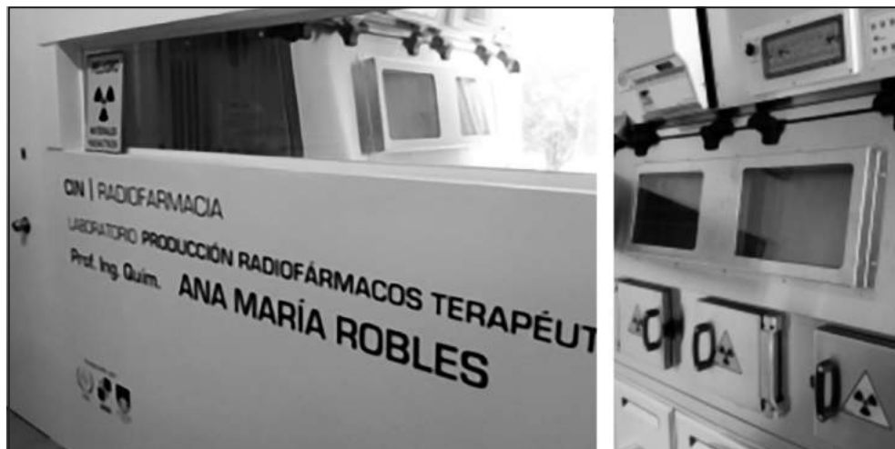
Figura 22. Celda de producción de radiofármacos terapéuticos, Centro de Investigaciones Nucleares, Facultad de Ciencias, Udelar
