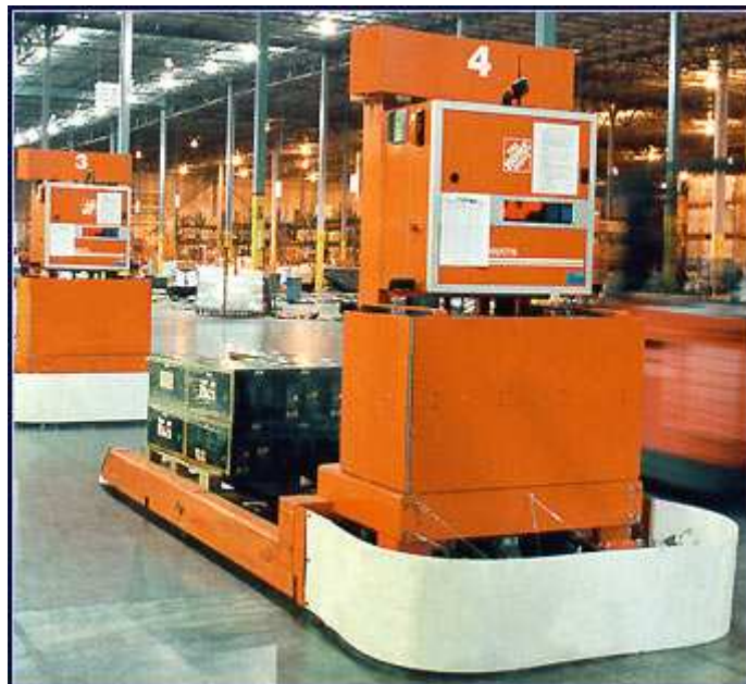
Fig. 37 - Um AGV, robô móvel do tipo que é usado na indústria para o transporte e armazenamento de materiais internamente.
