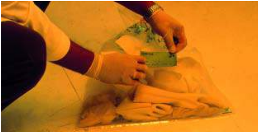
Preacondicionamiento y etiquetado de una bolsa que contiene residuos radiactivos de baja y media actividad
