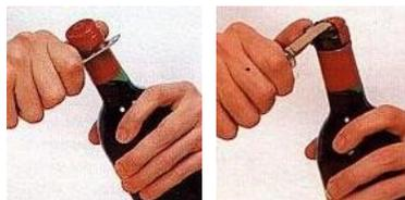
A remoção da cápsula também pode ser feita com o **corta-cápsulas** (“**foil-cutter**”), que é um acessório com a forma de “U”, cuja abertura abraça o gargalo. Pressionando no gargalo e girando, ele corta a cápsula através de disquinhos de aço existentes na sua base, mas em geral corta mais rente à borda do gargalo.
