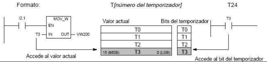
Figura 4-5 Acceder al bit del temporizador o al valor actual de un temporizador
