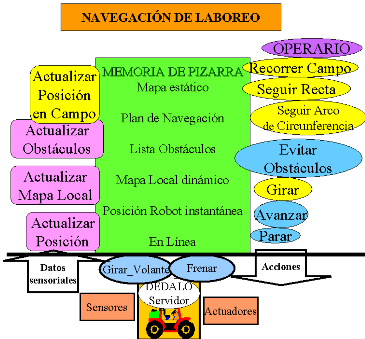
Figura 5.42 : Esquema completo de los agentes de la navegación específica de laboreo. Las elipses de color azul situadas a la derecha de la figura, corresponden a los agentes de actuación. Se han destacado en color amarillo los agentes de actuación nuevos que no existían en la navegación global. Los rectángulos con esquinas redondeadas en color rosa situados a la izquierda son los agentes perceptivos. En el centro de la imagen en color verde se muestra el contenido de la pizarra. La zona inferior de la figura muestra el servidor del robot, con los dos agentes básicos de locomoción Girar Volante y Frenar .
