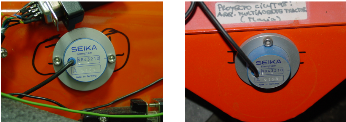
Figura 4.23 : Inclínómetros SEIKA integrados en el tractor DÉDALO: frontal a la derecha y lateral a la izquierda
