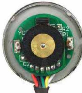
**Fig. 3.1.** Ejemplos de aplicaciones de codificadores rotativos incrementales: a) Hokuyo URG-04LX-UG01 Laser Rangefinder; b) Rueda de desplazamiento de un ratón informático; c) Codificador rotativo magnético aplicado en el eje de un motor DC.
