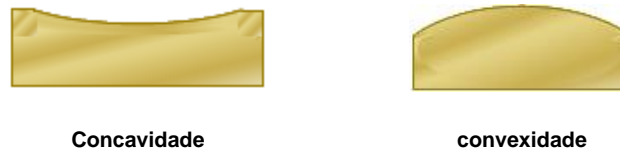
Figura 8 – Concavidade e Convexidade como Desvios de Planeza
