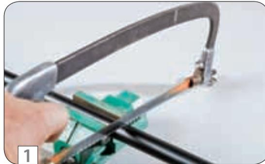
Con la sierra para metal cortar el trozo de barra de 1.20 m.
