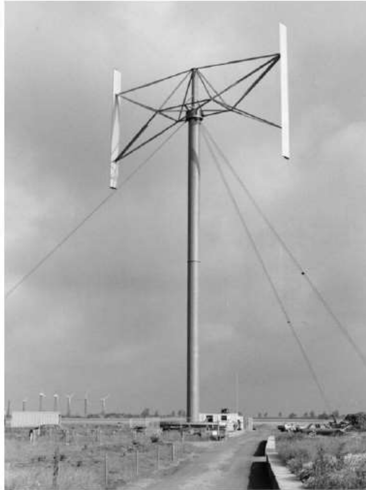
Figure 22: Aerogenerador tipo H con diámetro de rotor de 35 m y 300 kW de potencia
