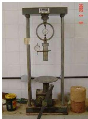
Figura 8.11 – Prensa para realização do ensaio de compressão simples.
