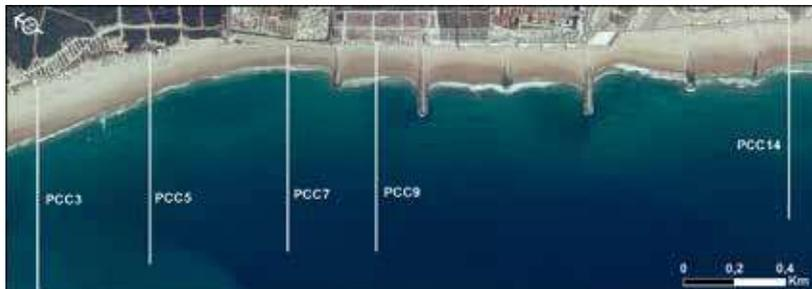
*Figura 6 - Seleção de perfis efetuados nos levantamentos topo-hidrográficos.*
