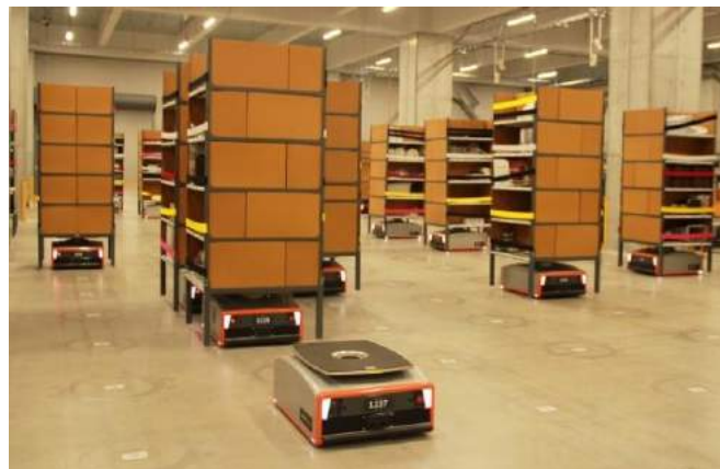
Figura 3. 13. Empleo de AGV en la gestión de almacenes con GreyMatter (GreyOrange, 2019)
