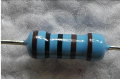
Fig. 5.5.20 Resistor de  $1,00\text{ k}\Omega \pm 1\%$  .
