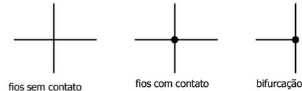
Fig. 5.5.4 Convenção para indicar contato entre ligações.
