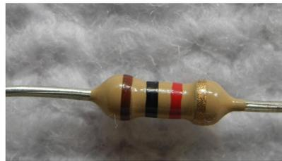
Fig. 5.5.19 Resistor de  $1,0\text{ k}\Omega \pm 5\%$  .
