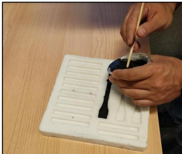
*Il·lustració XLIII - Molde de las probetas de plastisol con partículas metálicas.*
