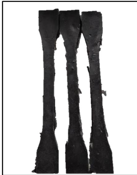
*Ilustración XLVII - Probetas de plastisol + 15% partículas metálicas +15% de fibras de basalto.*
