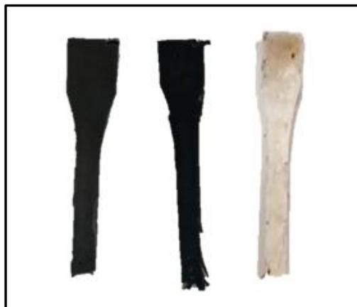
*Il·lustració L - Probetas ensayadas de plastisol + 30% PM, plastisol + 15%PM + 15%FB y plastisol + 30%FC.*
