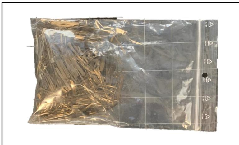
*Ilustración XXXV - Fibras de basalto*
