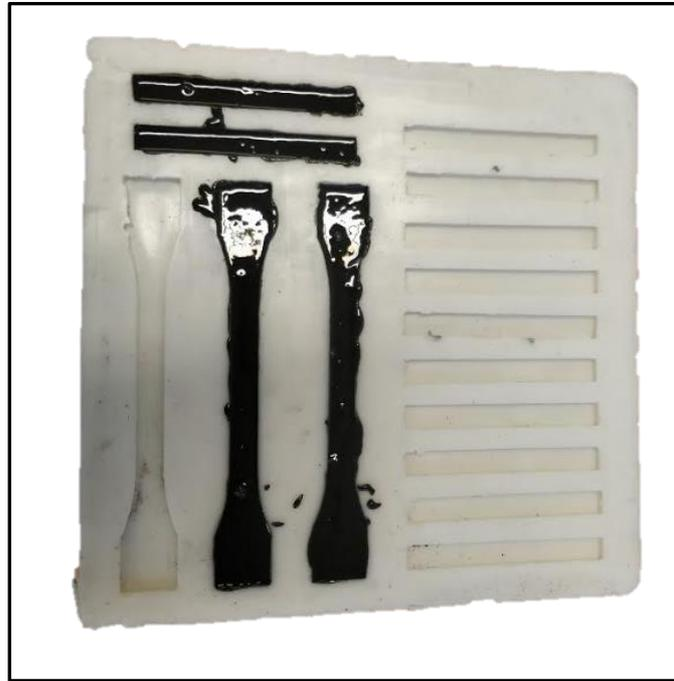
*Il·lustració XLIV - Molde de las probetas de plastisol con partículas metálicas II.*
