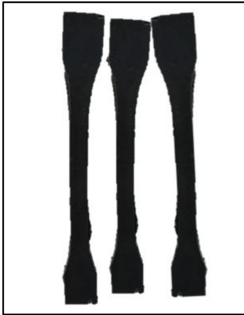
*Ilustración XLV - Probetas de plastisol + 30% partículas metálicas*
