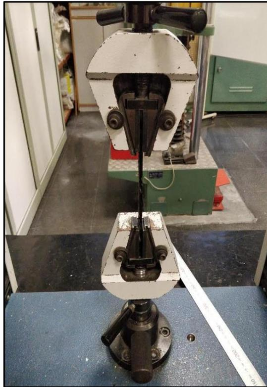
*Il·lustració XLIX - Màquina de tracció ensayando las probetas.*
