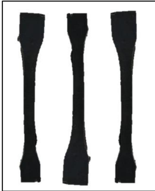
*Ilustración XLVI - Probetas de plastisol + 30% de fibras de basalto.*
