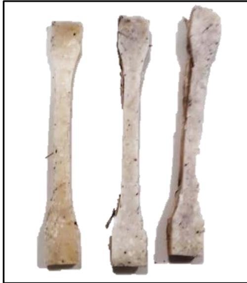
*Ilustración XLVIII - Probetas de plastisol + 30% fibras de coco.*
