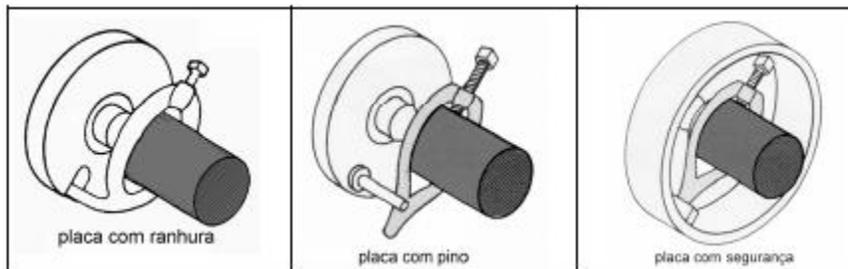
Em todas as placas usa-se o arrastador que é firmemente preso à peça, transmitindo-lhe o movimento de rotação, funcionando como órgão intermediário.
