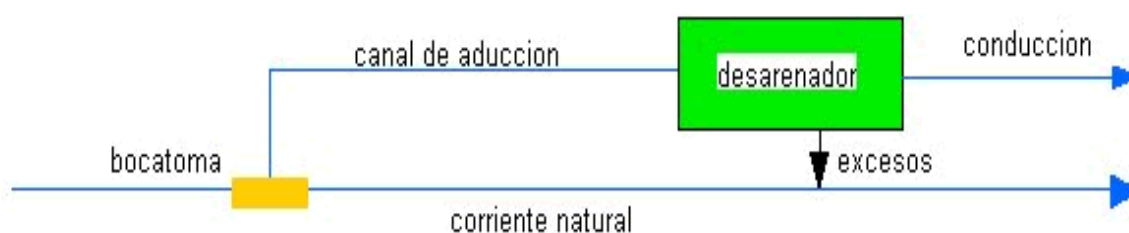
Fig. N° 49 Se observa el proceso de circulación de las aguas desde su captación.
