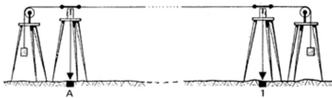
Esquema de la medida con cable invar.
