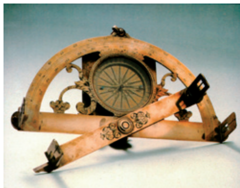
Arriba el grafómetro de pínulas y a la derecha un círculo holandés (h. 1650) (Museo Galileo).
