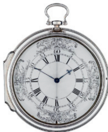
El cronómetro nº 4 (H4), de Harrison, que llevó el Capitán Cook en su segundo y tercer viaje alrededor del mundo (13 centímetros de diámetro y 1,45 Kg. de peso).
