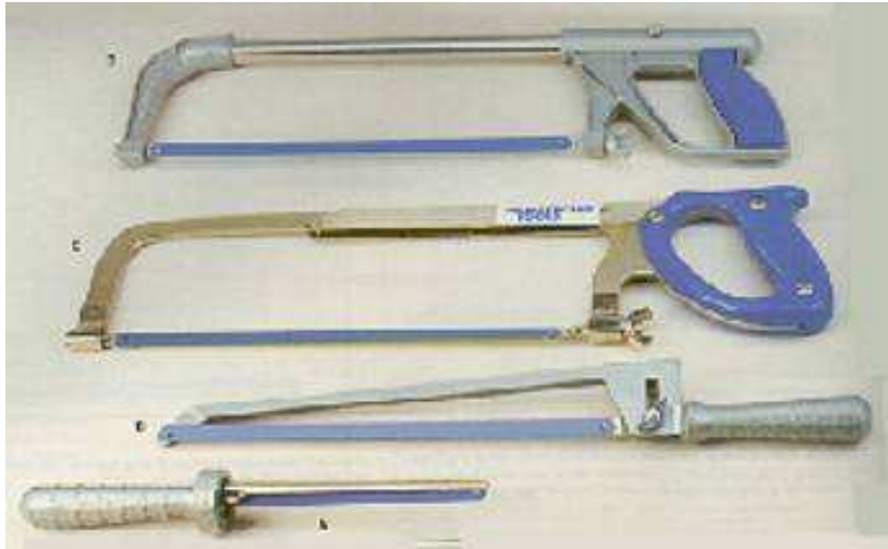
Figura C.6. Tipos de sierras, (A) para cortes a partir de una perforación, (B) para espacios reducidos, (C) y (D) con mango convencional. (Armstrong Tools)
