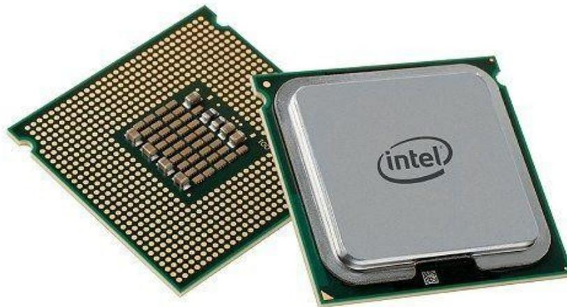
Um microprocessador, ou simplesmente processador, é um circuito integrado (ou chip), que é considerado o "cérebro" do computador (Figura a seguir). É ele que executa os programas, faz os cálculos e toma as decisões, de acordo com as instruções armazenadas na memória. Processador de computador
