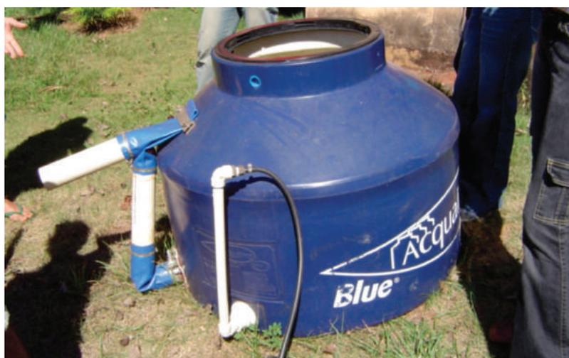
**Figura 19.3 - Caixas d'água para residências são excelentes e eficientes meios de transporte dos alevinos e com baixo custo tendo cano de escoamento de água e peixes, aeração, suspiro e tampa.**
