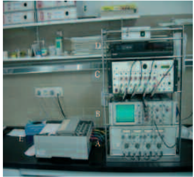
FIGURA 4. Columna para el registro de presiones. De abajo arriba y derecha a izquierda: etapa de amplificado y filtrado de las señales provenientes de los transductores de presión (A); osciloscopio para la visualización de las señales analógicas provenientes de los transductores (B); convertidor analógico-digital de 16 bits, convierte a digital las señales de presión (C); vídeo (D) e inscriptor (E).
