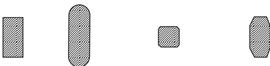
(a) Pilas de columna
