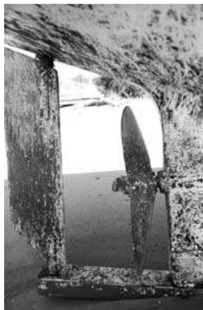
Figura 33: Ejemplo 2 de hélice mal instalada
