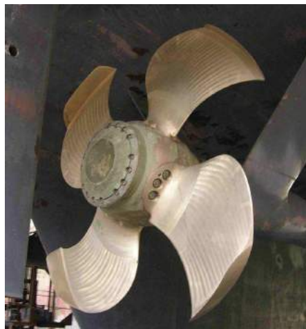
Figura 22: Hélice CLT instalada en buque
